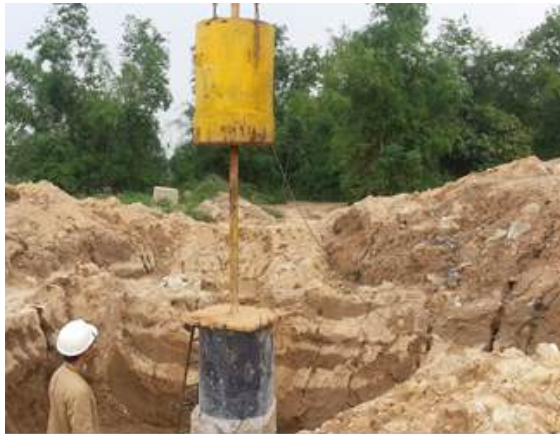
Thí nghiệm PDA – Cầu LRB04, Đường cao tốc Đà Nẵng-Quảng Ngãi
