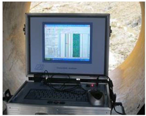
Siêu âm cọc khoan nhồi – Cầu Thạch Hãn, Quảng Trị
