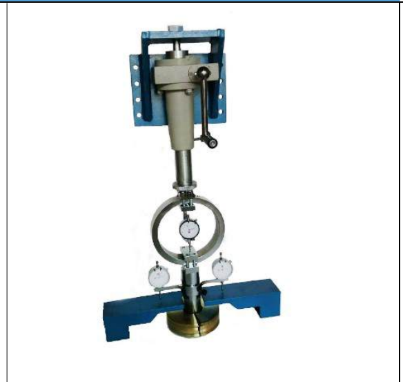
Thiết bị đo chỉ số CBR (California Bearing Ratio) ngoài hiện trường - Mã số BR-2 - GILSON - USA
