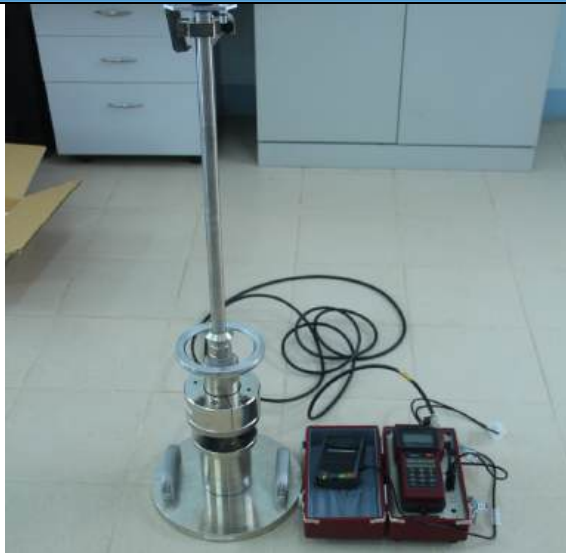
Thiết bị đo môđun đàn hồi động xung lực loại nhẹ LFWD (Light Falling Weight Deflection), Tokyo Sokki Kenkyujo Ltd – Japan
