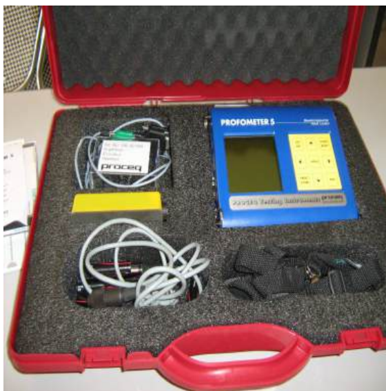
Máy xác định vị trí, đường kính còn lại của cốt thép-Anh Steel diameter and position determine – England
