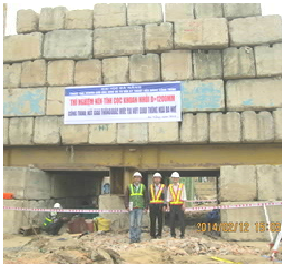
Nén tĩnh cọc khoan nhồi 1000T – Nút khác mức Ngã Ba Huế, Đà Nẵng
